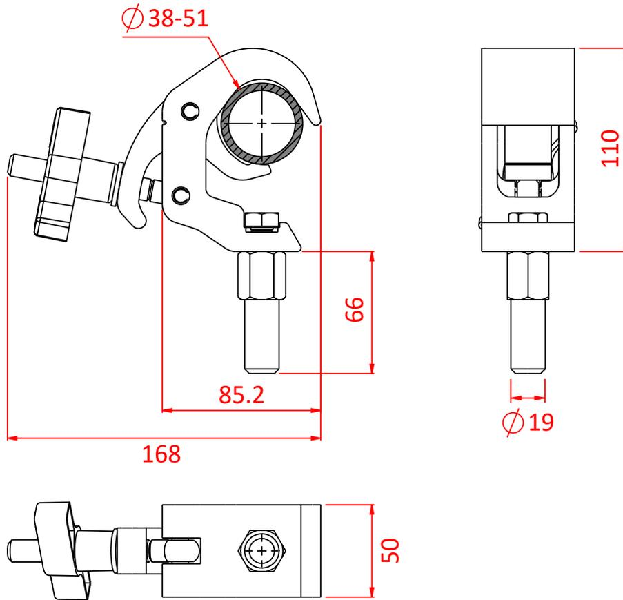
TYPICAL QUICK TRIGGER BEAMER CLAMP
