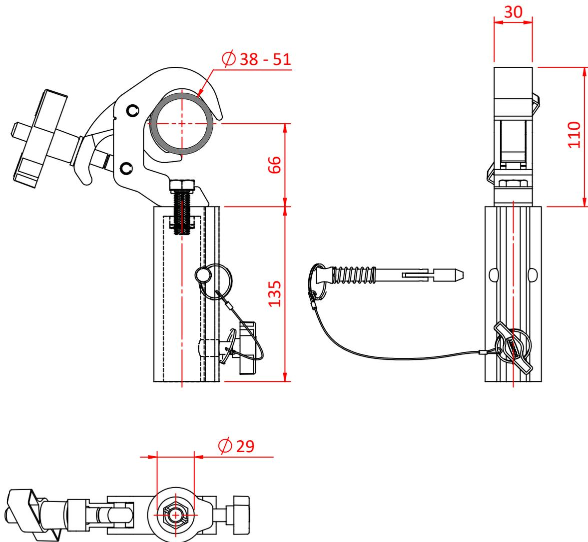
TYPICAL SLIMLINE QUICK TRIGGER BABY GRID CLAMP
