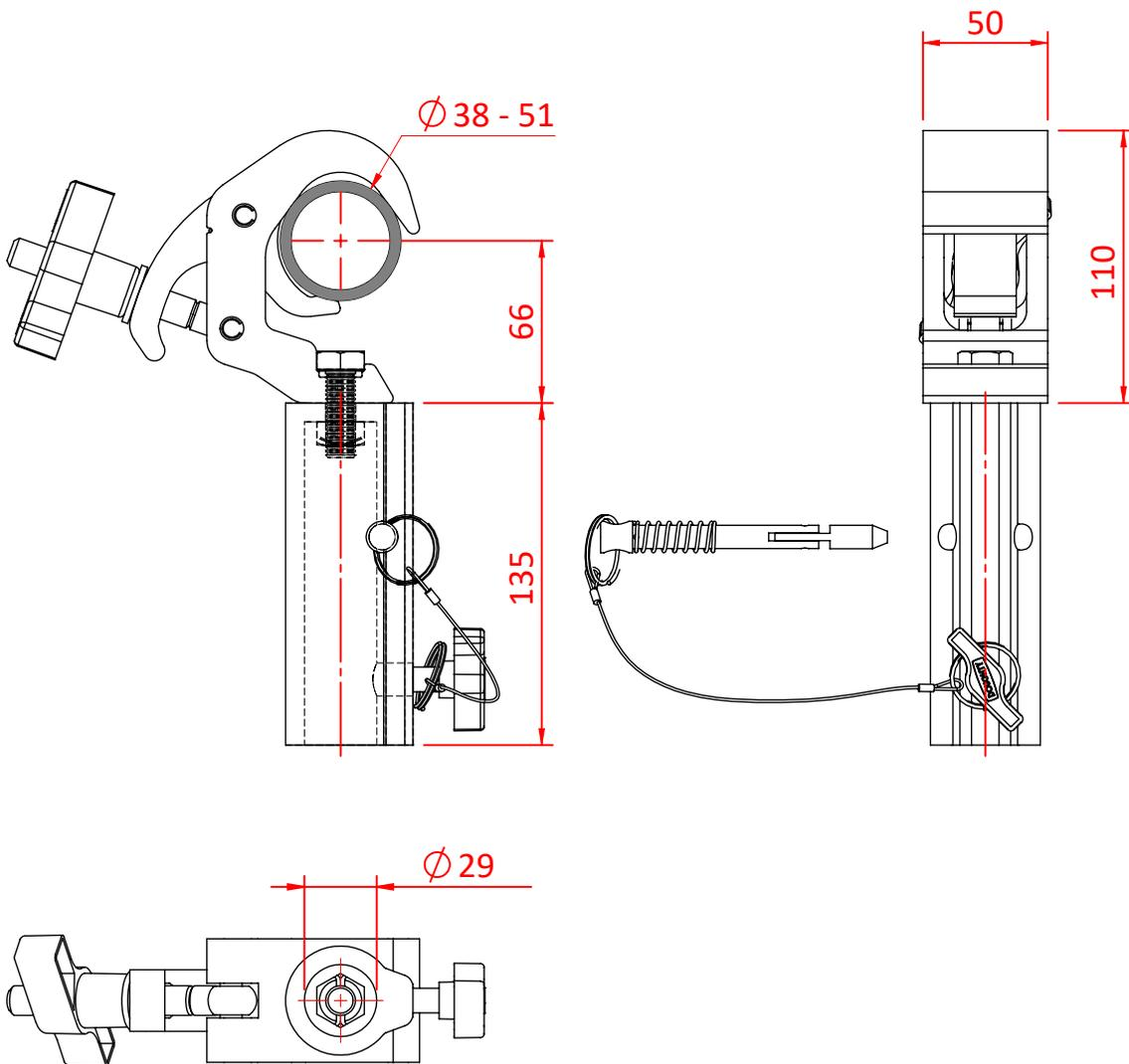
TYPICAL QUICK TRIGGER BABY GRID CLAMP
