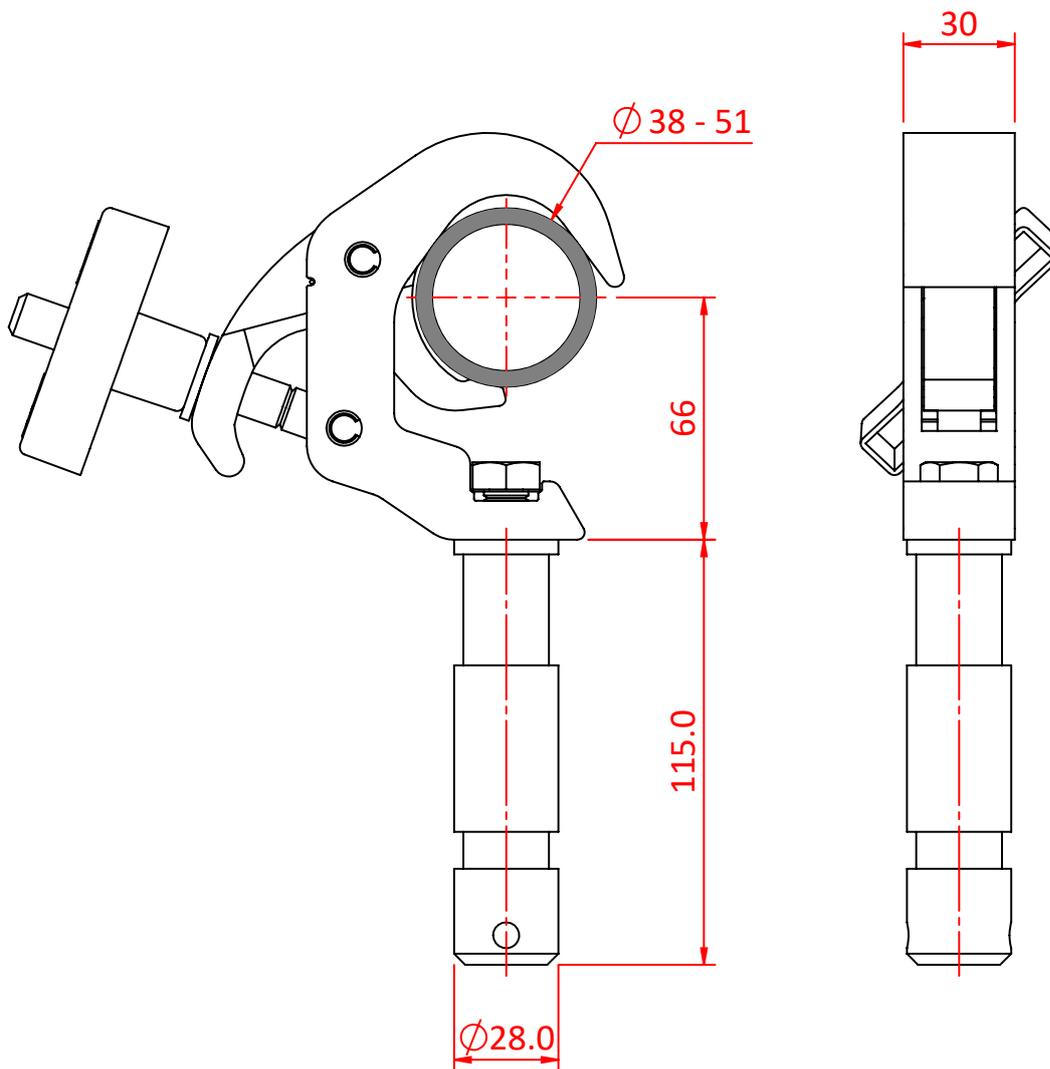
TYPICAL SLIMLINE QUICK TRIGGER TV CLAMP
