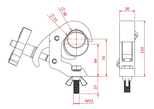
**TYPICAL TITAN QUICK TRIGGER CLAMP**
