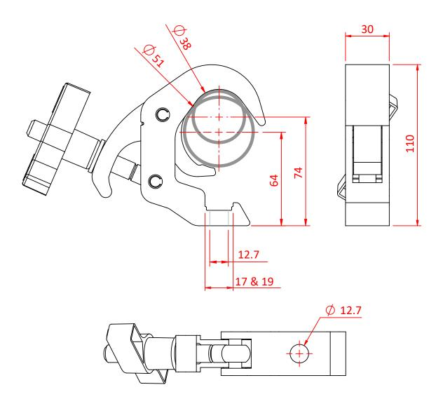
**TYPICAL SLIMLINE QUICK TRIGGER HOOK CLAMP**
