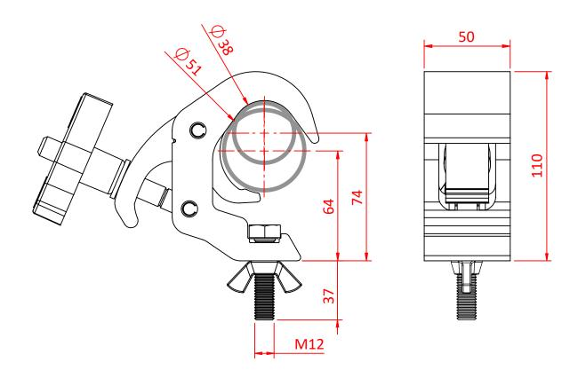
TYPICAL SLIMLINE QUICK TRIGGER CLAMP
