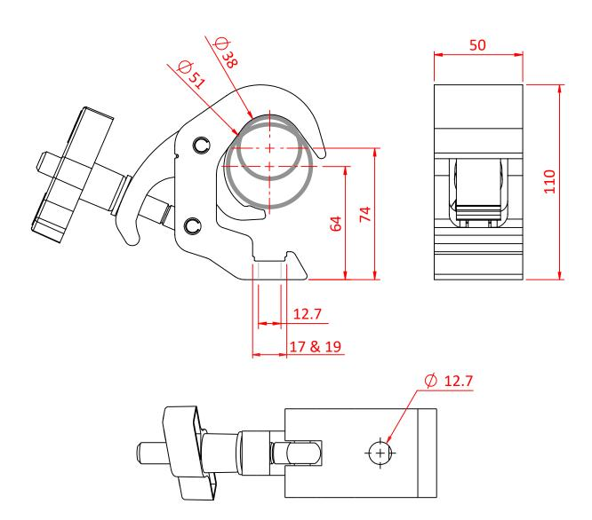
TYPICAL QUICK TRIGGER HOOK CLAMP
